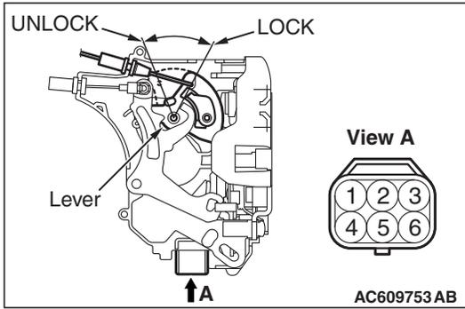
**STEP 7. Check the front door lock actuator (RH).**
